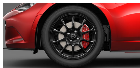
195/50R16 84Vタイヤ&16×7インチRAYS社製造アルミホイール(ブラック塗装)/ブレーキ(フロント: Brembo社製ベンチレーテッドディスク&Brembo社製対向4ピストンキャリパー(レッド塗装))/ブレーキ(リア:キャリパー(レッド塗装)) *メーカーセットオプション
