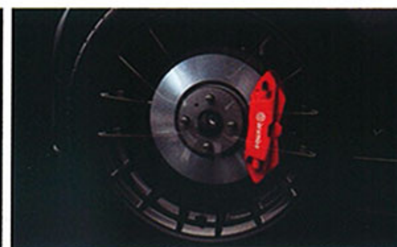
ブレーキ フロント Brembo社製ベンチレーテッドディスク & 対向4ピストンキャリパー(レッド塗装) [メーカーセットオプション: AT車のみ]
