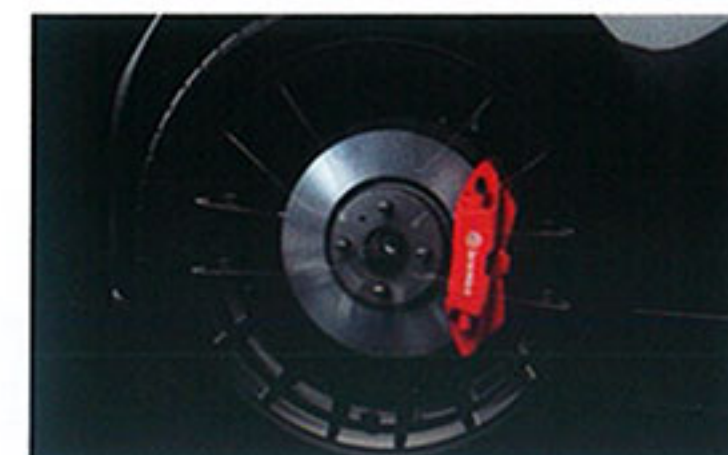
ブレーキ フロント Brembo社製ベンチレーテッド ディスク&対向4ピストンキャリパー(レッド塗装) [メーカーセットオプション]
