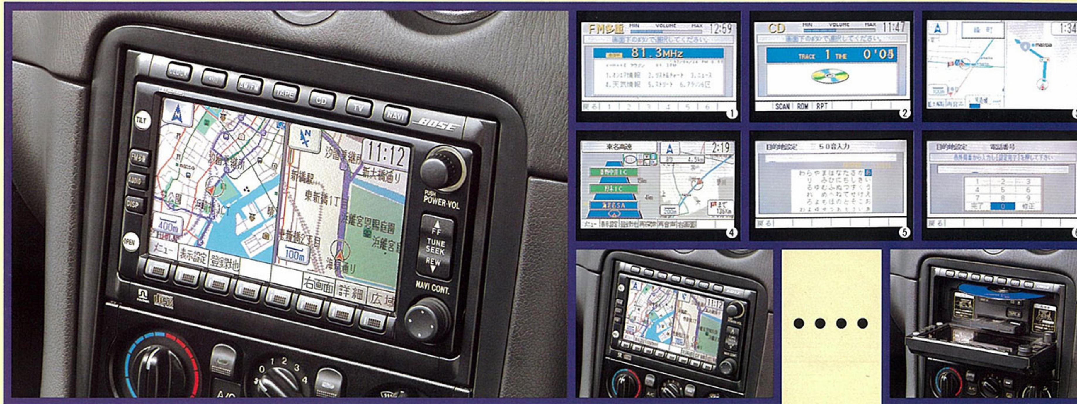
オーディオ機能を一体化、AVナビシステム。5.8型ワイド液晶ディスプレイを採用。高速の自動ルート計算機能、オートリルート機能などの基本性能に加え、交差点名音声ガイド、電話番号検索、FM文字多重表示など多彩な機能を満載。渋滞など最新の交通情報がキャッチできるVICSにも対応。また、FM(文字情報受信含む)AM、CD、カセット機能を一体化、BOSEサウンドシステムにも対応している。別売のTVチューナーを装着すればTV\*も楽しめる。(スペシャルパッケージ、RS、VSにメーカーセットオプション。VICSユニット、TVチューナー&TVアンテナはディーラーオプション。)\*ナビゲーション使用時、CDを聴くことはできません。安全のため走行中はTV画面は映りません。
