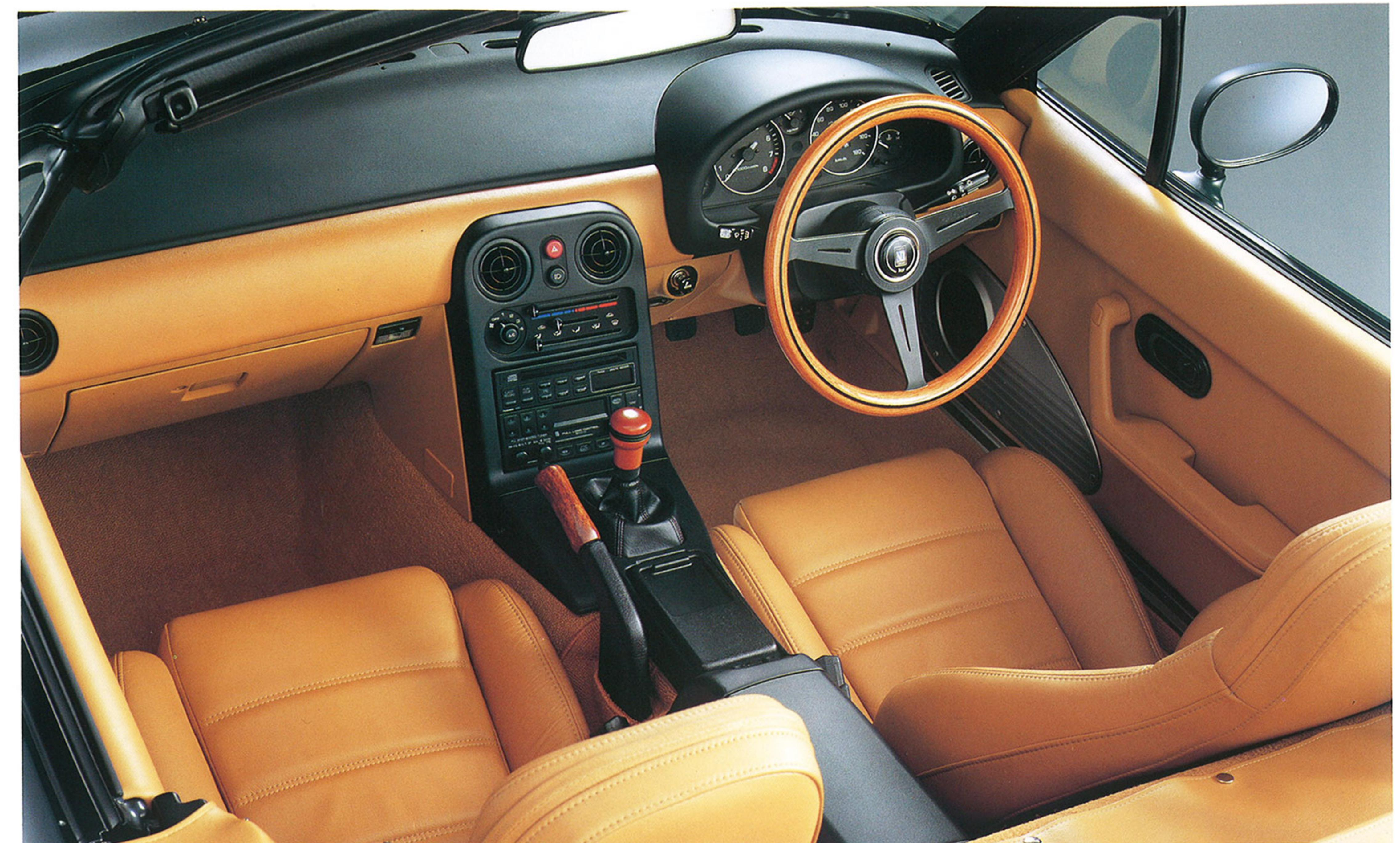
キャビンは、ドライバーとクルマの緊密な一体感をもたらすタイトな2シーター。ショートストロークの5段マニュアルシフトレバー、ヒール&トゥが容易なペダル配置などとともに、ダイレクトな操作フィールを提供。4段オートマチック車は、エンジンの専用チューンなどにより、ダイレクトで俊敏なレスポンスを実現している。
