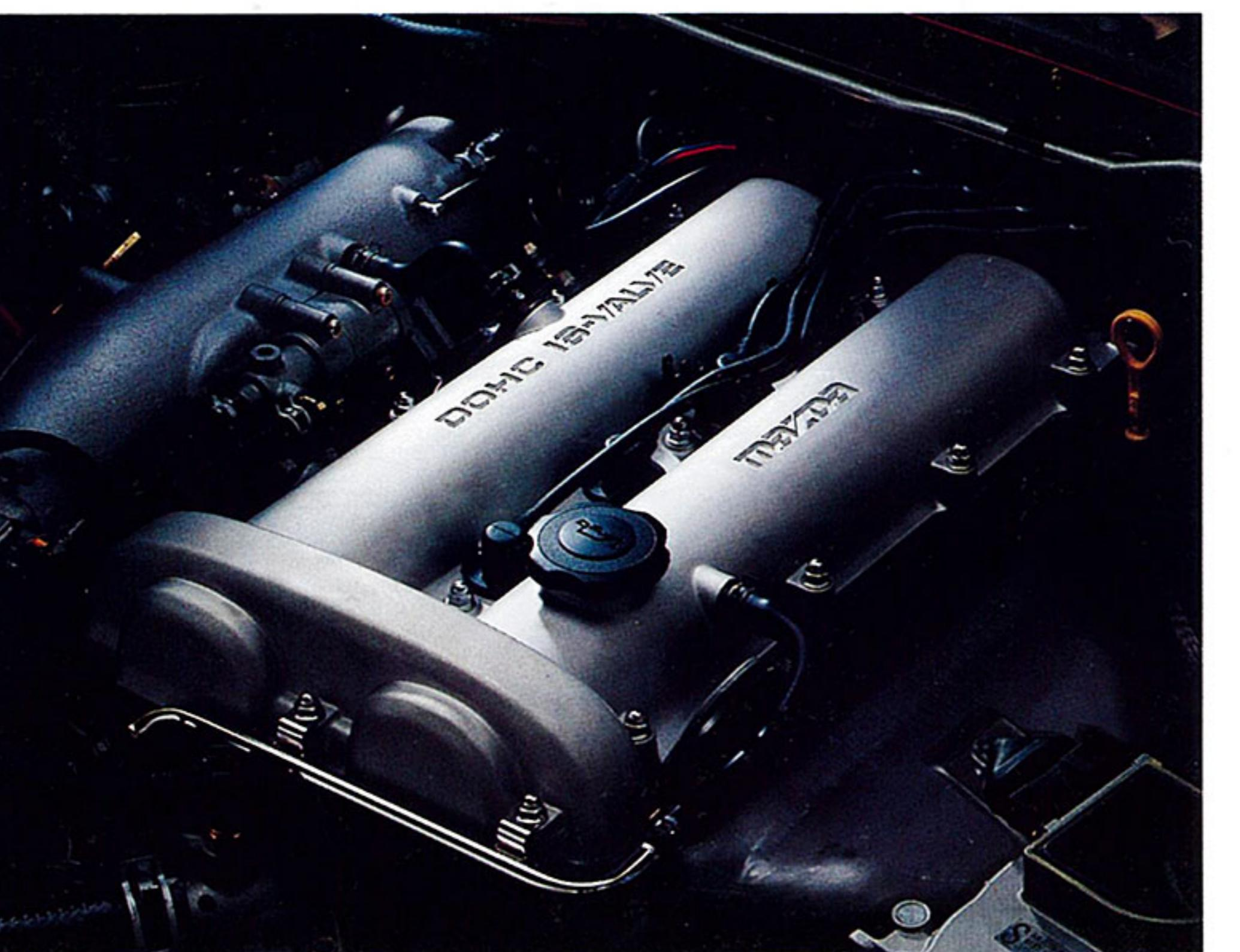
kg-m/4500rpmに設定。ダイレクトで軽快で俊敏な走りが、意のままに満喫できる楽しさを実現している。また、クランクシャフトやフライホイールに高い剛性を与え、アルミ铸造オイルパンをトランスミッションケースと直結させるなど、エンジンの振動を抑え、回転サウンドをより軽快で心地よいものとするための工夫も、各所に凝らした。エンジンの造形美に対するこだわりも大き
