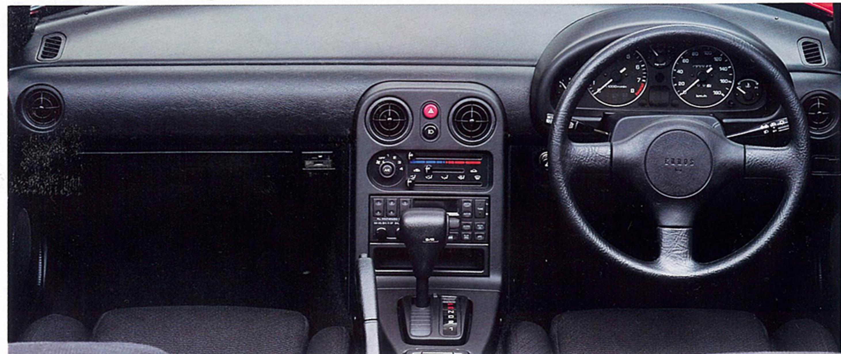
PHOTO:パワーウィンドー・パワーステアリング・オートパワー・アンテナ装着車、エアコンはショッピングオプション
