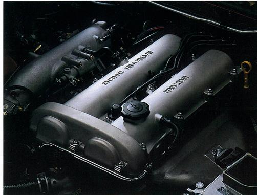
やフライホイールに高い剛性を与え、アルミ铸造オイルパンをトランスミッションケースと直結させるなど、エンジンの振動を抑え、回転サウンドをより軽快で心地よいものとするための工夫も、各所に凝らした。こうした動力性能の洗練とともに、エンジンの造形美に対するこだわりも大きく、カムカバー2本とベルトカバーを一体成型したアルミ製シリンドーヘッドカバーを与えている。補機
